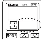
基准值设定在次显示屏进行，主显示屏不转换
