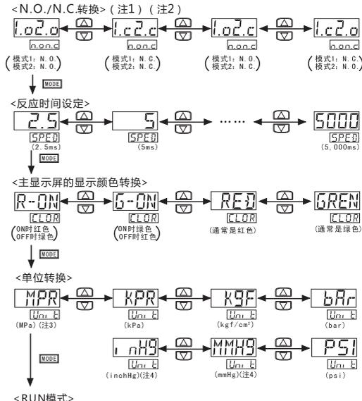
注1: 比较输出2模式设定为“OFF”时, N.O./N.C.转换显示, 正压型, 负压型, 连成压型均相同。
